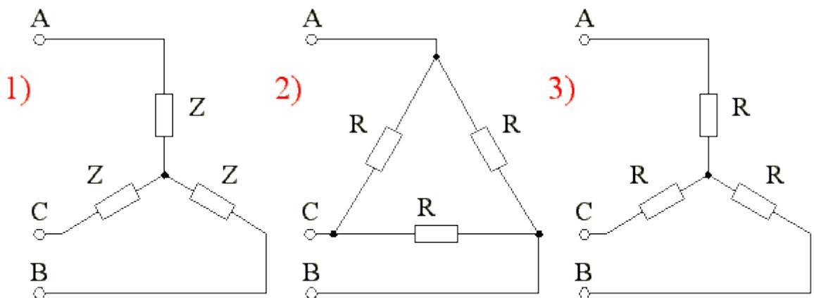
По схеме внешних соединений определить способ соединения обмоток трёхфазного трансформатора.
