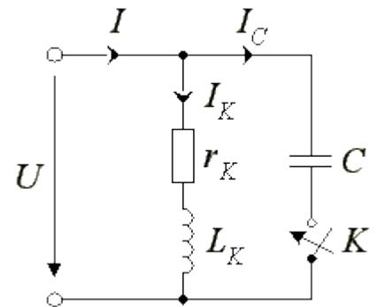
Определить показания ваттметра, если  $U = 200$  В,  $R = X_L = X_C = 5$  Ом.
