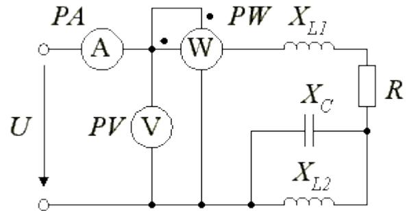
Определите полное сопротивление цепи, если  $X_L = 6$  Ом, а приборы показывают:  $P_W = 32$  Вт,  $I_A = 2$  А?
