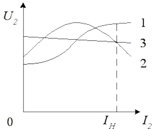
На рисунке показаны механические характеристики двух механизмов и двигателя. Какой из механизмов можно запустить этим двигателем?
