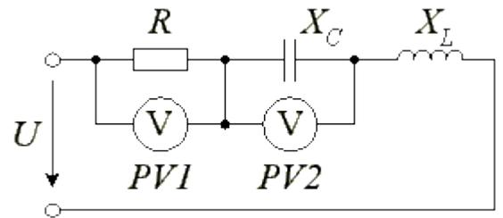
Для данной электрической схемы определить векторную диаграмму, если  $X_C > X_L$ .
